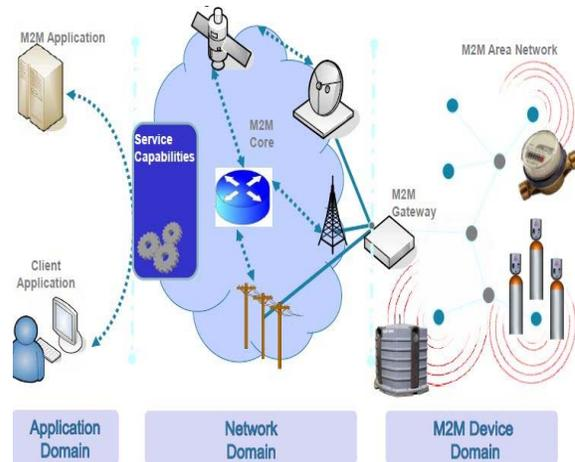
FIGURE 1. A SIMPLE M2M ARCHITECTURE
